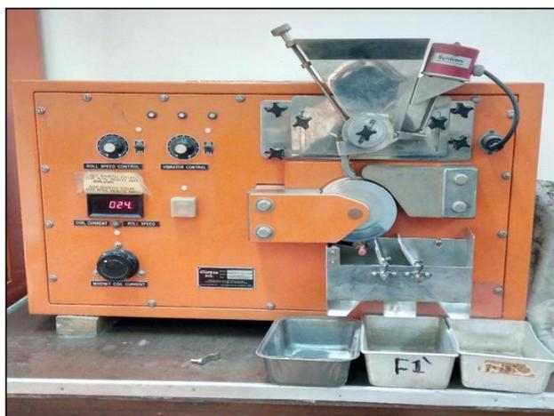
Рис. 1. Высокоинтенсивный магнитный сепаратор МН(13)111-5
