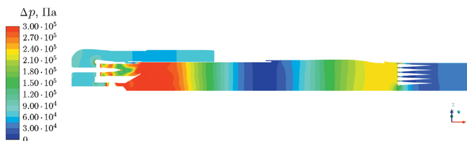
Рис. 9. Распределение среднеквадратичных значений колебаний давления газа в продольном сечении камеры сгорания, проходящем через ось одной из периферийных горелок
