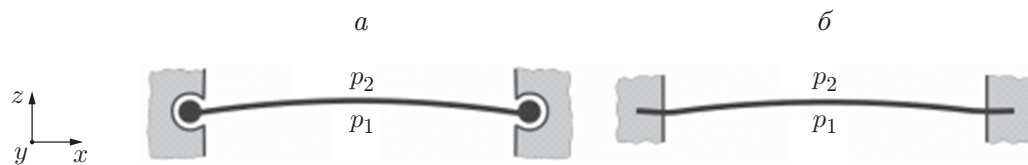
Рис. 1. Цилиндрический изгиб пластины с изолированными кромками: а — шарнирное закрепление, б — жесткая заделка
