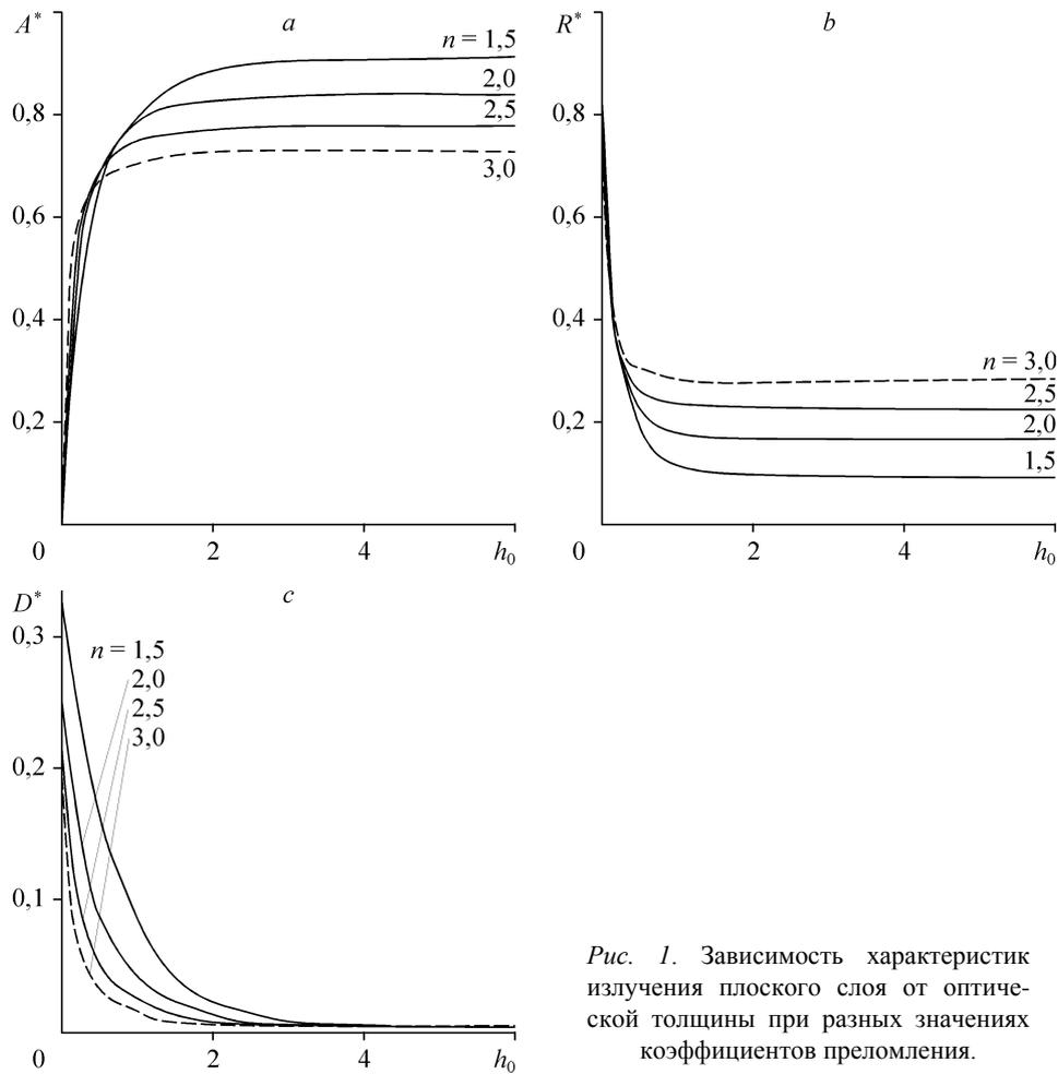
Рис. 1. Зависимость характеристик излучения плоского слоя от оптической толщины при разных значениях коэффициентов преломления.
