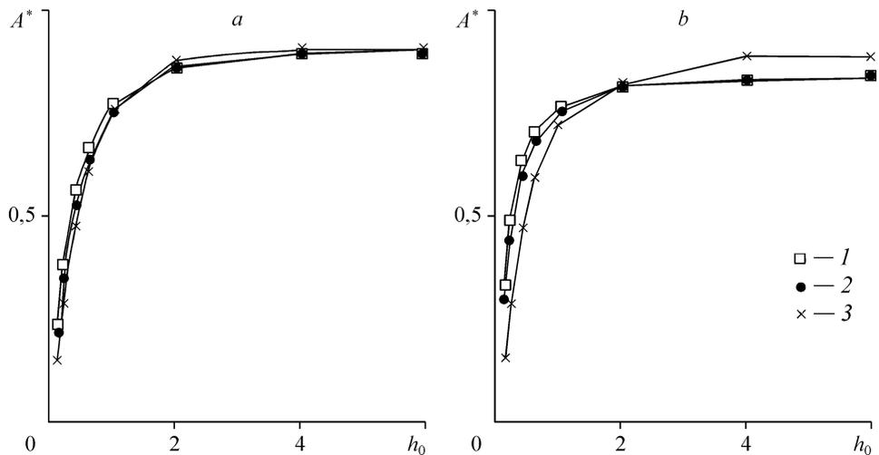
Рис. 4. Зависимость поглощательной способности сферы от оптической толщины  $h_0 = \alpha r_c$  для двух значений показателя преломления  $n = 1,5$  (а) и  $2,0$  (б) с учетом: значения  $R$  (1), значения  $R_{\text{эф}}$  (2), данных работы [4] (3).
