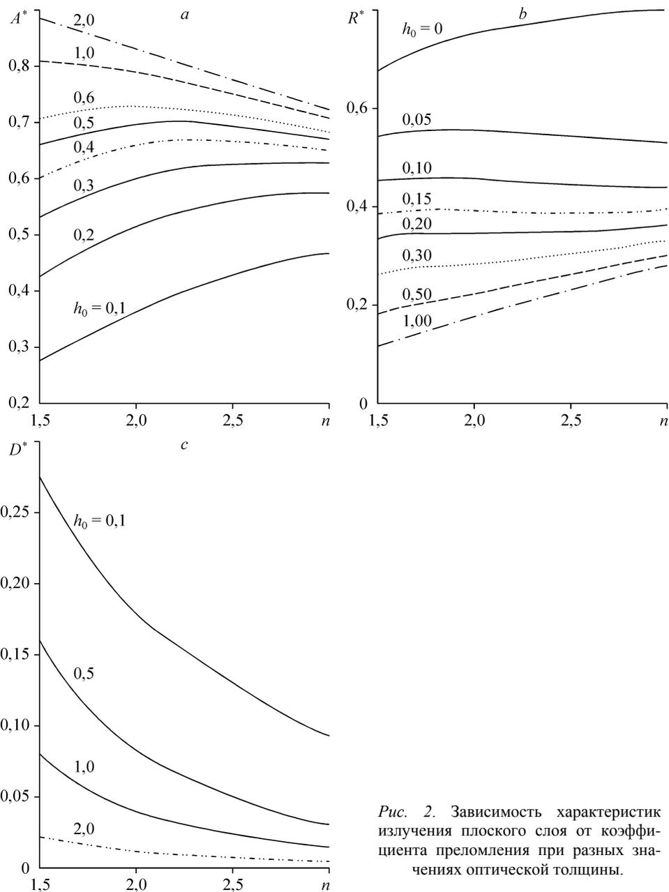
Рис. 2. Зависимость характеристик излучения плоского слоя от коэффициента преломления при разных значениях оптической толщины.
