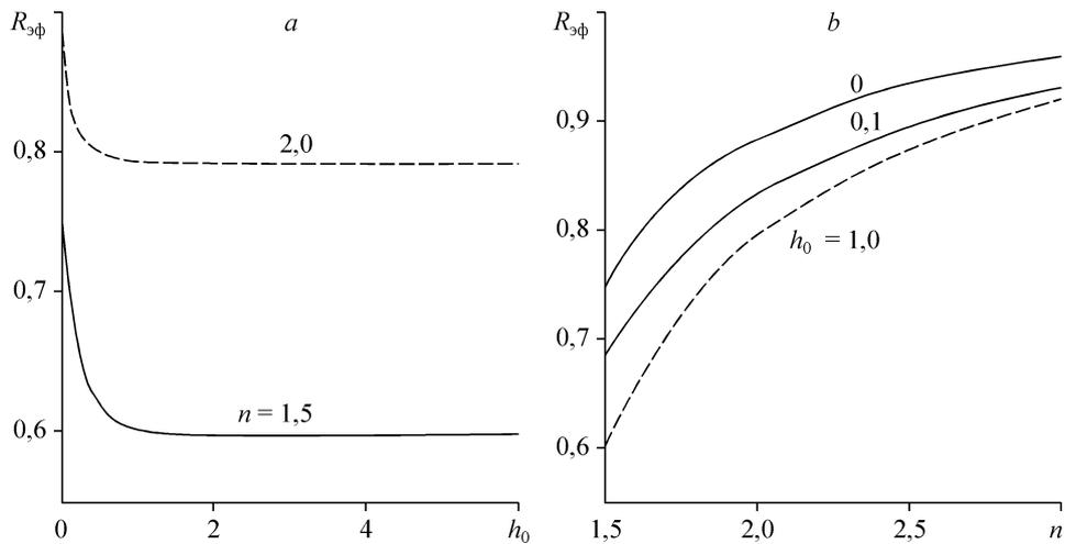
Рис. 3. Зависимость эффективного коэффициента отражения внутренней поверхности  $R_{\text{эф}}$  плоского слоя: от оптической толщины при двух значениях коэффициента преломления  $n$  (а) и от показателя преломления при трех значениях оптической толщины  $h_0$  (б).
