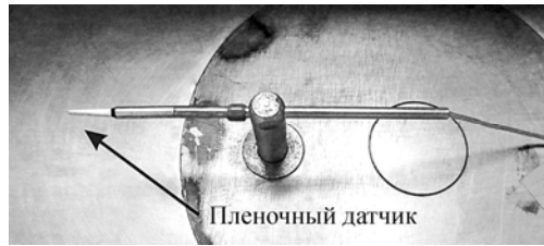
Рис. 2. Клиновидный пленочный термоанемометрический датчик DANTEC 55R31, установленный в невозмущенном потоке рабочего участка аэродинамической трубы.
