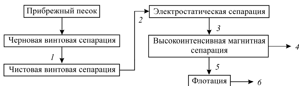
Рис. 1. План извлечения монацита и циркона из прибрежного песка: 1 — концентрат черновой сепарации; 2 — тяжелые минералы; 3 — непроводящие минералы; 4 — магнитные минералы (монацит); 5 — немагнитные минералы; 6 — флотационные хвосты (циркон)
