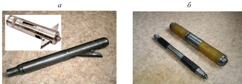
Рис. 1. Оборудование для проведения направленного и поинтервального гидроразрыва угольного пласта: *а* — щелеобразователи ЩМ-1 и ЩУ-Г; *б* — полиуретановый герметизатор с переменной жесткостью УПГ-42 и полиуретановый герметизатор УПГ-76
