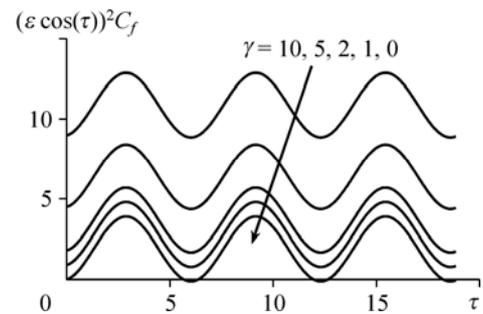
Рис. 9. Коэффициент поверхностного трения для разных значений  $\gamma$ .  $\xi = 1$ .
