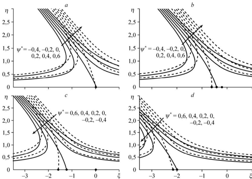
Рис. 2. Линии тока при  $\tau=0$  (а),  $\pi/4$  (б),  $\pi/2$  (с),  $\pi$  (д) в случаях  $M=0$  (штриховые линии), 2 (сплошные линии).  $\gamma=2, \beta=2, \varepsilon=1$  и  $\text{Pr}=0,7$ .
