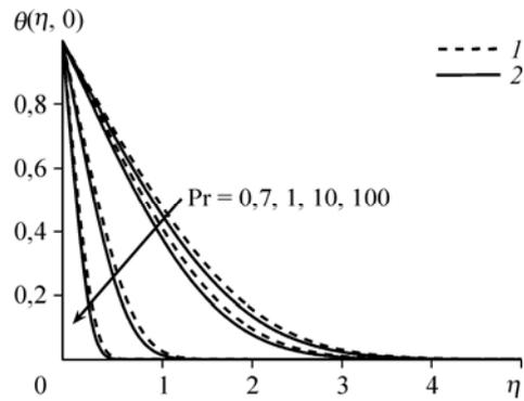
Рис. 7. Профиль температуры  $\theta(\eta)$  для разных значений  $Pr$ .  $M = 0$  (1),  $0,2$  (2).
