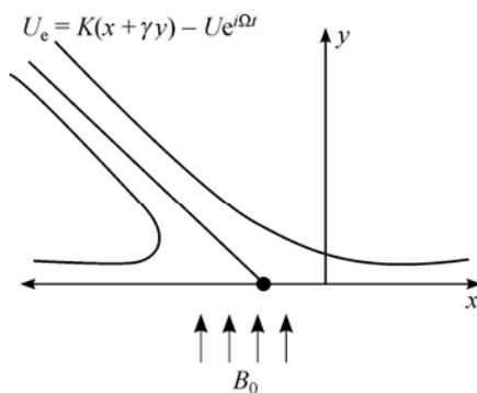
где  $u$  и  $v$  — это  $x$ - и  $y$ -компоненты скорости соответственно,  $t$  — время,  $\nu$  — кинематическая вязкость,  $\sigma$  — электропроводимость,  $B_0$  — напряженность однородного магнитного поля,  $\rho$  — плотность жидкости,  $T$  — температура жидкости,  $C_p$  — удельная теплоемкость,  $k$  — теплопроводность жидкости. Граничные условия
