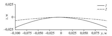
*Puc.* 5. Форма сухого пятна в пленке воды на медной пластине для случая:  $\alpha = 60^{\circ}$ ,  $q = 1 \cdot 10^{-5}$  м $^2$ /с, Re = 10.
