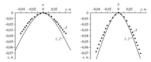
*Рис. 3.* Расчетные формы сухого пятна в пленке силиконового масла на стекле и их сравнение с расчетными и экспериментальными данными [9] ( $\alpha$  = 15°,  $\theta_0$  = 30°).
