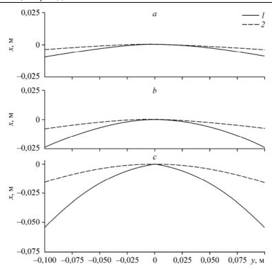
*Рис. 4.* Сравнение формы сухого пятна в пленке воды на медной пластине, рассчитанной по данному методу (*I*) и по методу [9] (2) ( $\alpha$  = 90°,  $\theta$ <sub>0</sub> = 52°).
