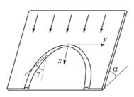
также считать, что поперечное сечение валика имеет форму кругового сегмента (рис. 2), причем в каждом поперечном сечении сегмента течение вдоль валика имеет профиль скоростей  $u(\xi, \eta) = (g_{\alpha\gamma}/v)(\eta^2/2 - \eta \cdot h(\xi)),$
