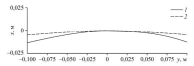
*Рис.* 6. Форма сухого пятна в пленке воды на медной пластине для случая:  $\alpha = 30^{\circ}$ ,  $q = 1 \cdot 10^{-5}$  м $^2$ /с, Re = 10.
