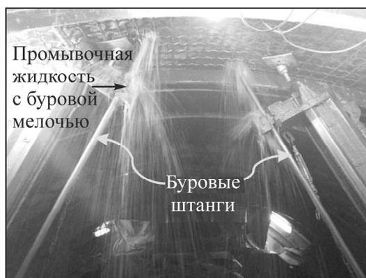
Рис. 2. Гидравлическая вращательно-ударная буровая машина Sandvick Power Pack HP555, работающая на NJHPP
