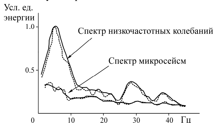
Рис. 3. Обобщенные спектры низкочастотных сейсмических колебаний и микросейсм над областью очистных работ
