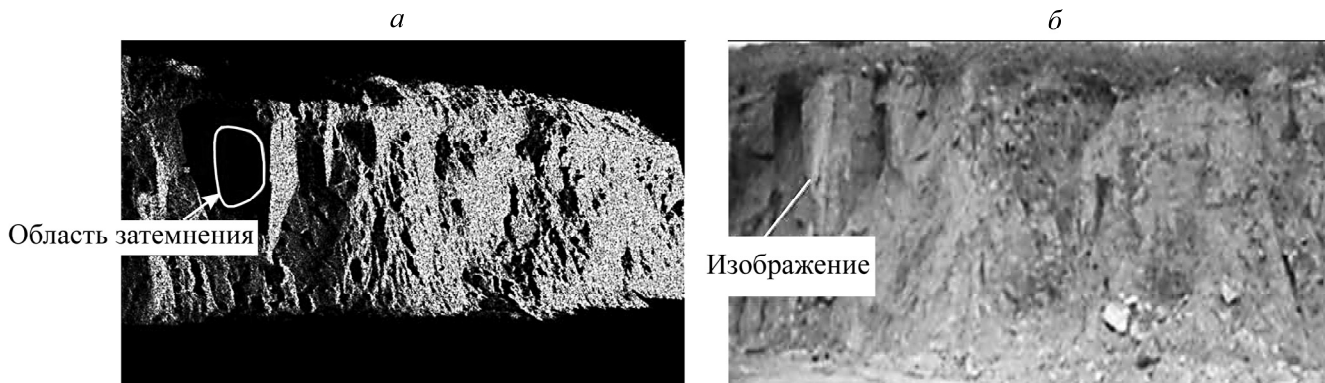
Рис. 6. Сравнение фотографического снимка и снимка, полученного при помощи лазерного сканирования, демонстрирующее влияние помех — открытые поверхности могут быть не охвачены при наблюдениях с помощью единичной линии прямой видимости: а — затемнение при лазерном 3D-сканировании; б — реальное изображение
