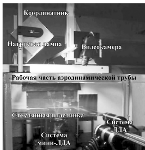
Рис. 3. Фотография рабочей части аэродинамической трубы с установленным миниатюрным термоанемометром FlowLite фирмы Dantec, а также с оптической установкой, реализующей измерения методом интерферометрии масляной пленки.
