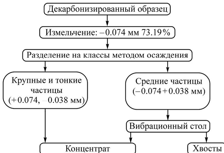
Рис. 8. Схема обогащения ванадия, содержащегося в каменном угле
