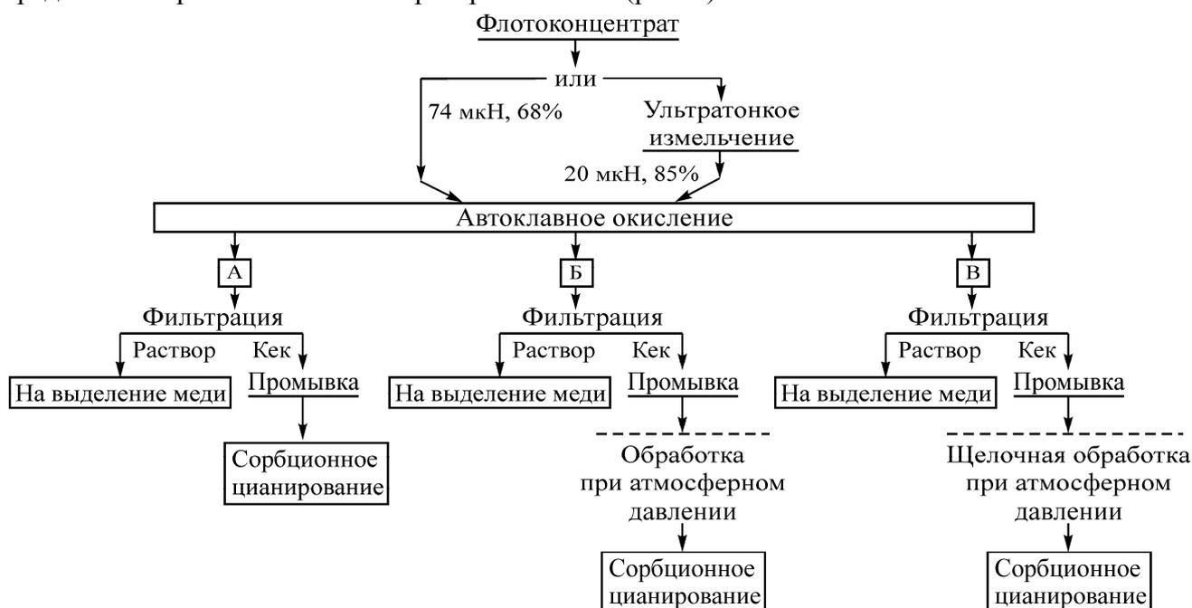
Рис. 1. Лабораторные технологические схемы: А — прямое цианирование кека автоклавного окисления; Б — предварительная обработка при атмосферном давлении с последующим цианированием; В — предварительная щелочная обработка при атмосферном давлении с последующим цианированием
