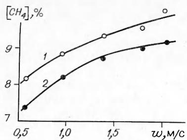
Рис. 2. Пределы срыва бунзеновского конуса пламени метановоздушных смесей (обозначения аналогичны рис. 1).
