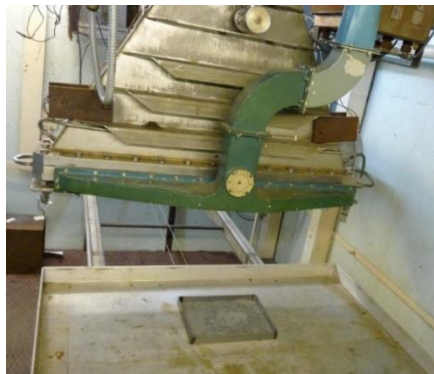
Рис. 3. Размещение транспортера и емкости с обрабатываемой рудой в помещении технологического зала ускорителя ИЛУ-6
