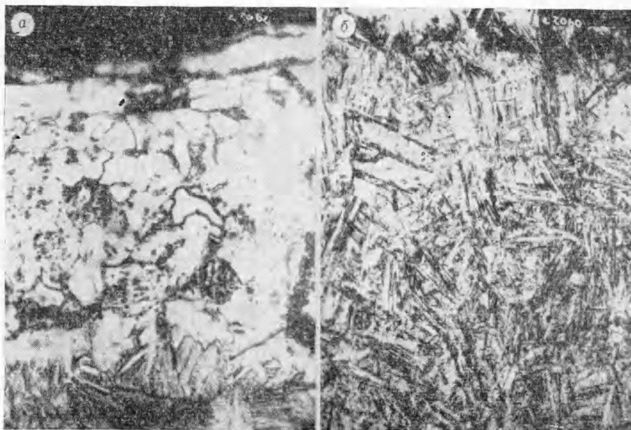
Рис. 8. Микроструктура края реза. Титановый сплав ОТ-4-1, толщина образца 6 мм, мощность лазерного излучения 375 Вт.
