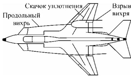
Рис 1. Несимметричный взрыв вихрей в окрестности скачков уплотнения над крыльями летательного аппарата.
