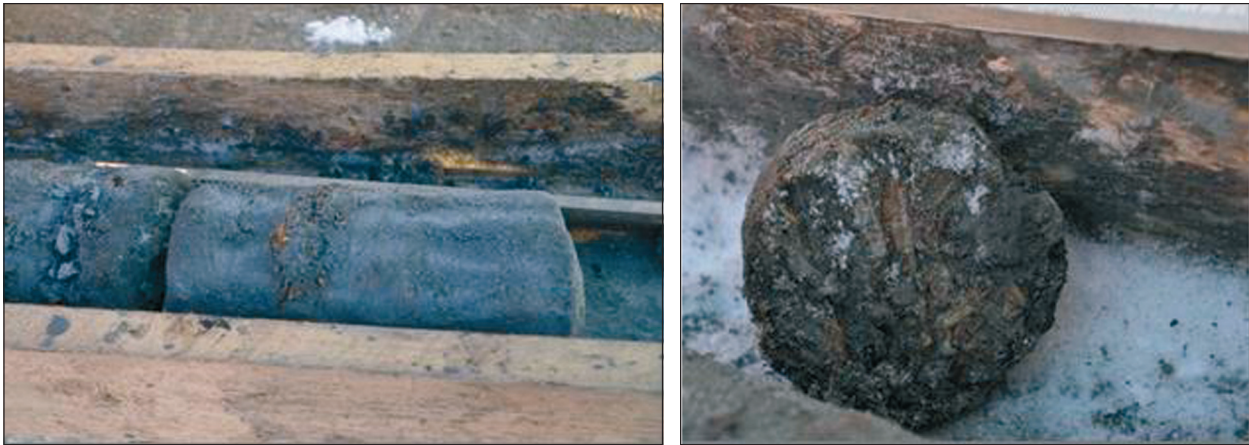
Рис. 5. Керн морской скв. ВК-2, представленной плотным слоистым песком с большим количеством растительного детрита (скв. ВК-2, апрель, 2012 г.).
