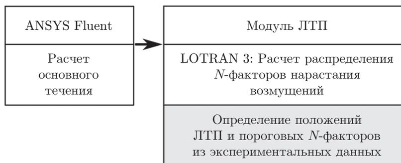
Рис. 1. Алгоритм определения  $N$ -факторов и положения ЛТП на аэродинамических конфигурациях
