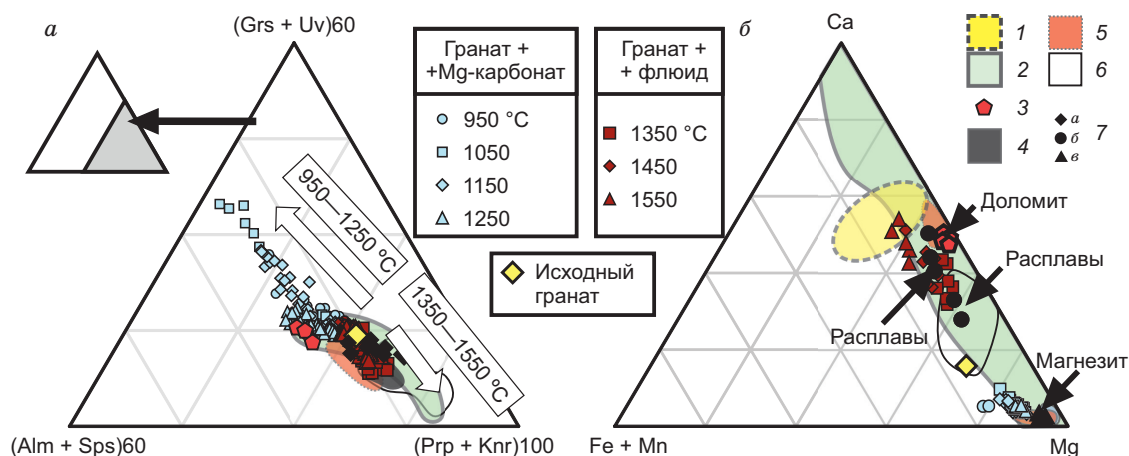
Рис. 7. Составы сосуществующих гранатов (а), карбонатных фаз и закаленной части флюида (б), полученных в экспериментах в системе \text{Gr}_{\text{Lz}}-\text{CO}_2 при давлении 6.3 ГПа в диапазоне температур 950—1550 °С, а также состав исходного граната.
