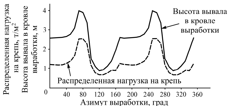
Рис. 1. Оптимальные направления проходки выработки по условию минимизации нагрузки на крепь
