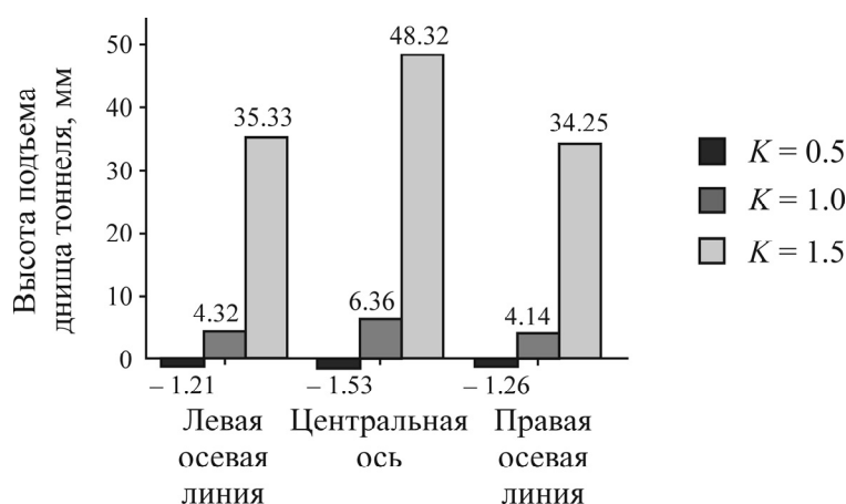
Рис. 2. Поднятие днища тоннеля при трех режимах нагружения
