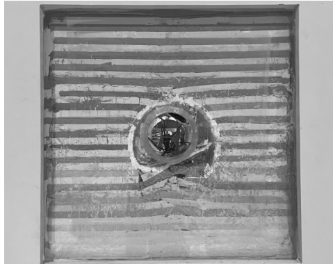
Рис. 3. Разрушение слоистого днища тоннеля при большом горизонтальном напряжении
