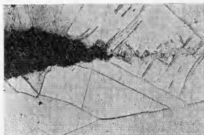
Рис. 2. Картина развития трещины в меди цепочкой пересекающихся двойников, \times 400 .
