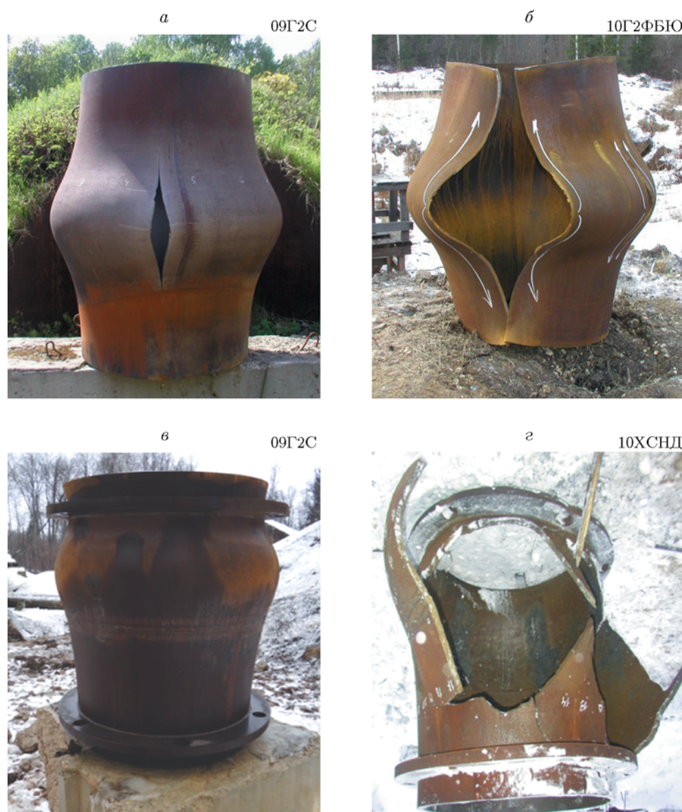
Рис. 7. Состояние тонкостенных ( \varepsilon_0 = 3.6 \% ) (а, б) и толстостенных ( \varepsilon_0 = 6 \% ) (в, г) оболочек из [14] после нагружения зарядами взрывчатого вещества предельной массы 17.75 (а, б) и 24.30 кг ТЭ (в, г)
