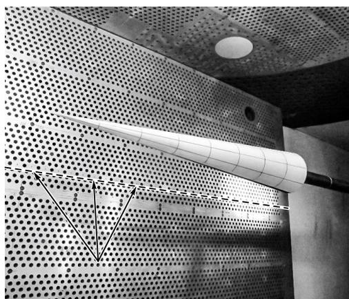
с помощью внутримодельных тензометрических весов, донное давление, распределение давления на стенках рабочей части, нестационарное давление в трех точках на боковой поверхности конуса (рис. 2) — датчиками Kulite XCS-062-5D. Вдоль осевых линий четырех стенок рабочей части, а также верхней и нижней стенок сопла располагались отверстия для измерения статического давления. Измерение распределения давления
