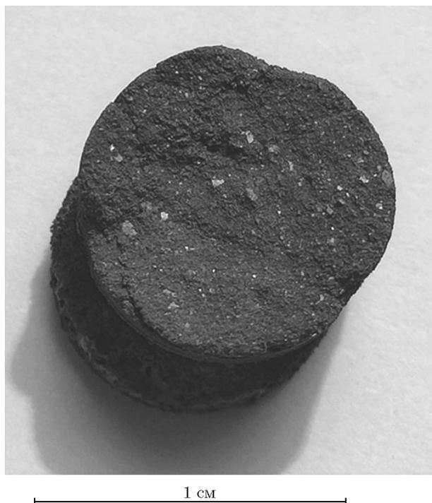
Рис. 9. Фотография излома продуктов горения активированной смеси Ni + Al + 1.25Mn
