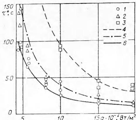
Зависимость времени задержки воспламенения образца от величины поджигающего теплового потока.
