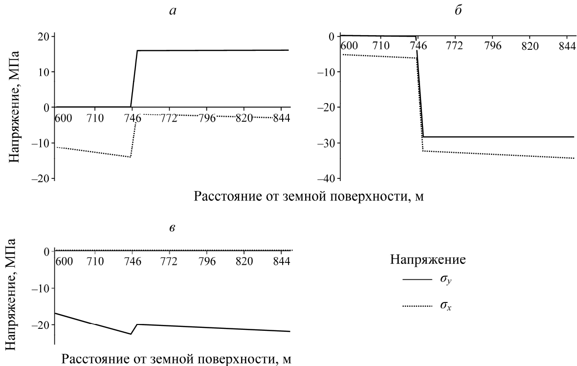
Рис. 1. Зависимость нормальных температурных напряжений от расстояния до земной поверхности вблизи контакта слоев с различными теплофизическими и механическими свойствами: а — вариант 1; б — вариант 2; в — вариант 3
