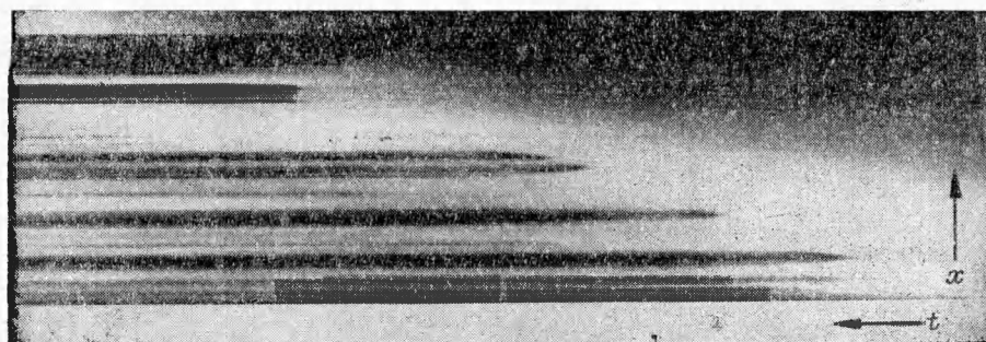
Рис. 2. Распространение упругой волны в стеклянной пластине.
