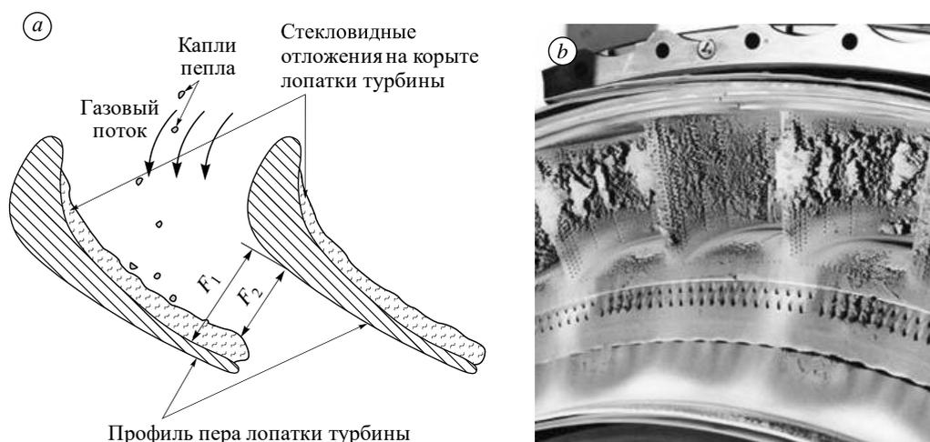
Рис. 1. Стекловидные отложения на поверхности первого соплового аппарата: схема отложений (а) и снимок соплового аппарата первой ступени двигателя RB211-524D4, подвергнувшегося выключению в полете вследствие попадания вулканического пепла (б).
