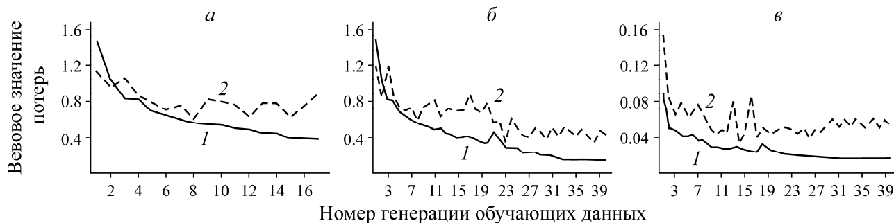
Рис. 9. Диаграммы потерь при следующих стержневых архитектурах: ResNet50 (а); ResNet101 (б); ResNet152 (в): 1 — потери при проверке; 2 — потери при обучении
