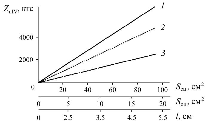
Взаимосвязь пиковых усилий резания при вырыве включений  $Z_{\text{IV}}$  с поверхностью их сцепления с угольным массивом  $S_{\text{сц}}$ , поверхностью опоры  $S_{\text{оп}}$  и длиной  $l$  включений при сильной (1), нормальной (2), слабой (3) связи твердых включений с окружающим угольным массивом
