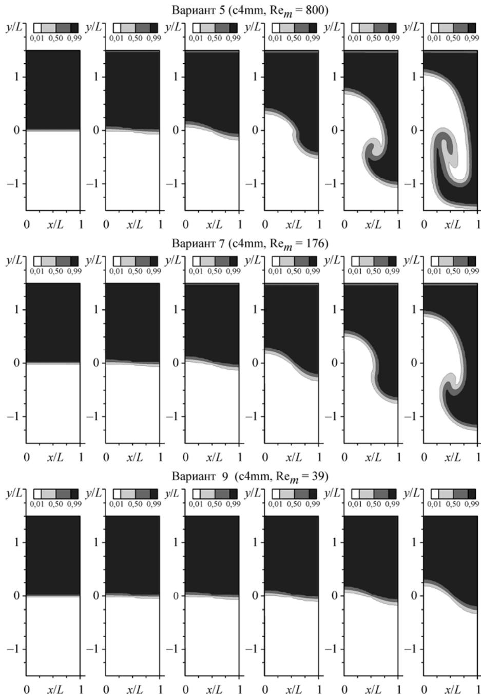
Рис. 3. Изолинии объемной фракции более тяжелой жидкости при  $t/t_r = 0,0; 1,6; 3,2; 4,8; 6,4; 8,0$  для вариантов 5, 7, 9 (расчеты при различных числах Рейнольдса, с нулевым поверхностным натяжением).
