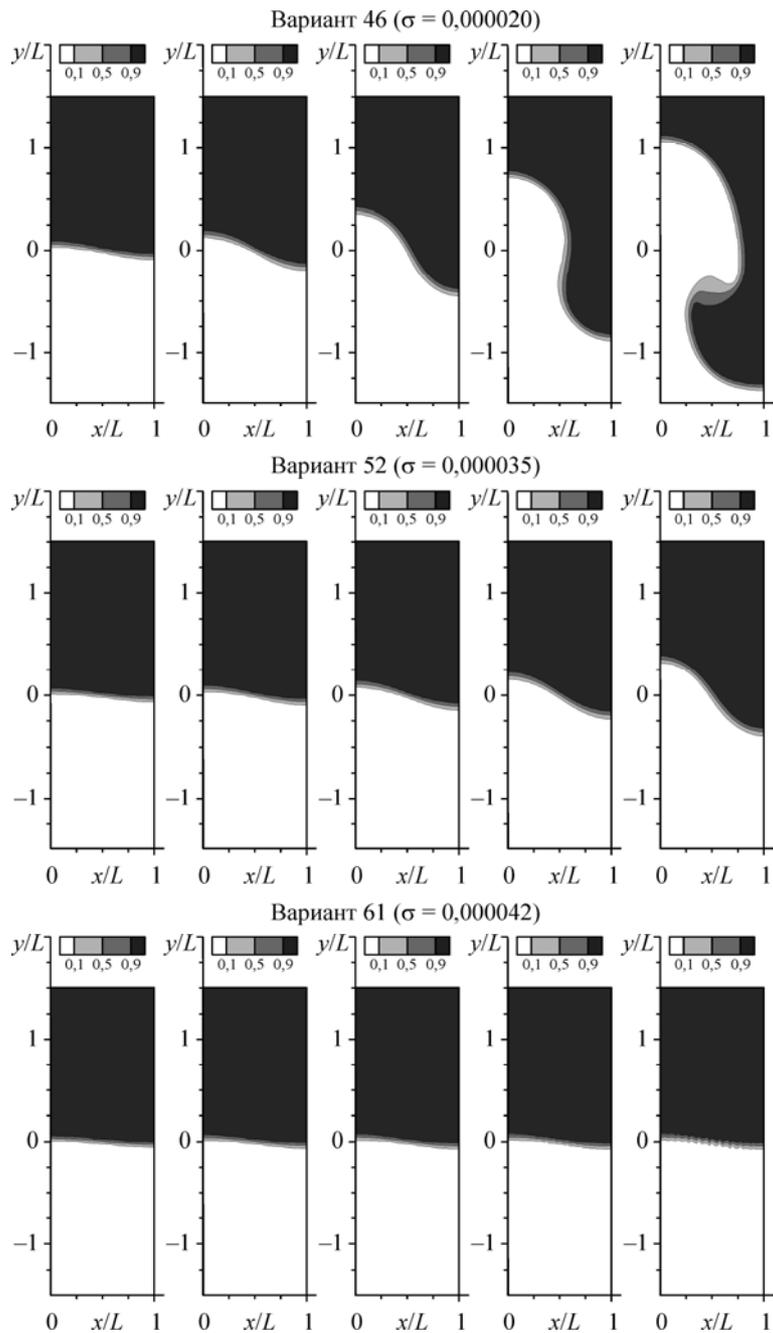
Рис. 7. Объемная фракция при  $t/t_r = 3,2; 4,8; 6,4; 8,0; 9,6$  для вариантов 46, 52, 61 (с поверхностным натяжением).
