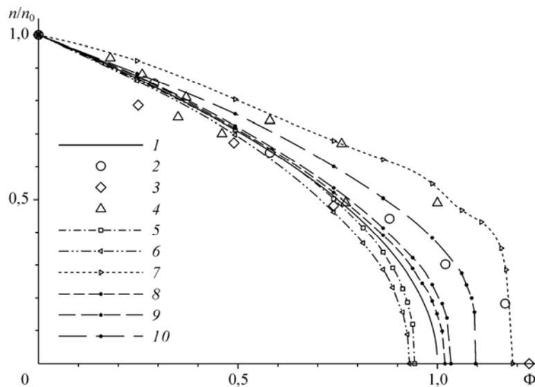
Рис. 9. Скорость роста неустойчивости Рэля–Тейлора: теоретическая кривая [3] (1), данные расчетов [1, 6] (2, 3), измерений [4] (4) и настоящей работы (5–10), построенные как точки (символы) для различных вариантов в зависимости от параметра устойчивости
