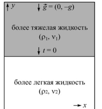
Рис. 1. Схема задачи НРТ (начальное состояние).
