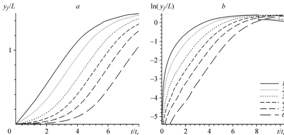
Рис. 2. Эволюция по времени среднего значения амплитуд «клина» и «пузыря» (а) и логарифма этого среднего значения (б) для вариантов 1–6 (с вариацией коэффициента  $A$ , при нулевом поверхностном натяжении).
