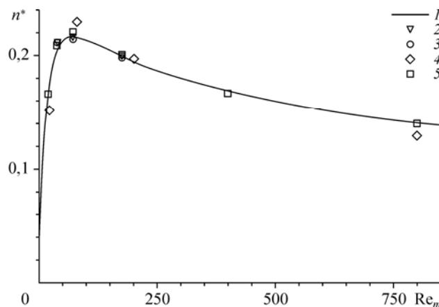
Рис. 5. Скорость роста неустойчивости Рэлея–Тейлора: теоретическая кривая [3] (1), данные вычислений [5] (2), расчетов по схеме SMF [10, 11] (3), c4mm [9] (4) и настоящей работы со схемой c4mm (5), построенные как точки (символы) для различных вариантов в зависимости от числа Рейнольдса.
