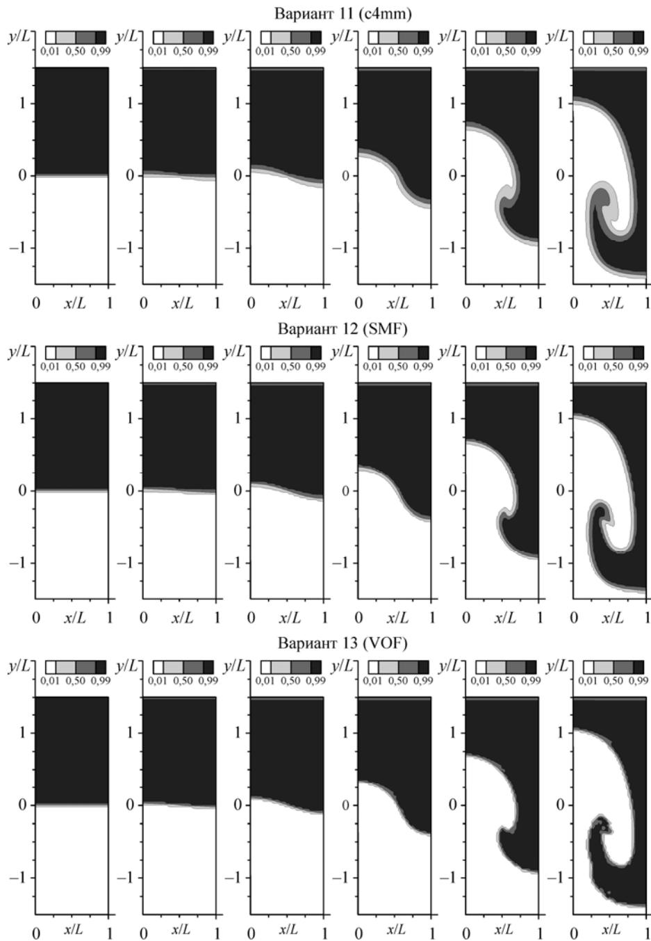
Рис. 6. Изолинии объемной фракции более тяжелой жидкости при  $t/t_r = 0,0; 1,6; 3,2; 4,8; 6,4; 8,0$  для вариантов 11–13 (расчеты с различными схемами адвекции, без поверхностного натяжения).
