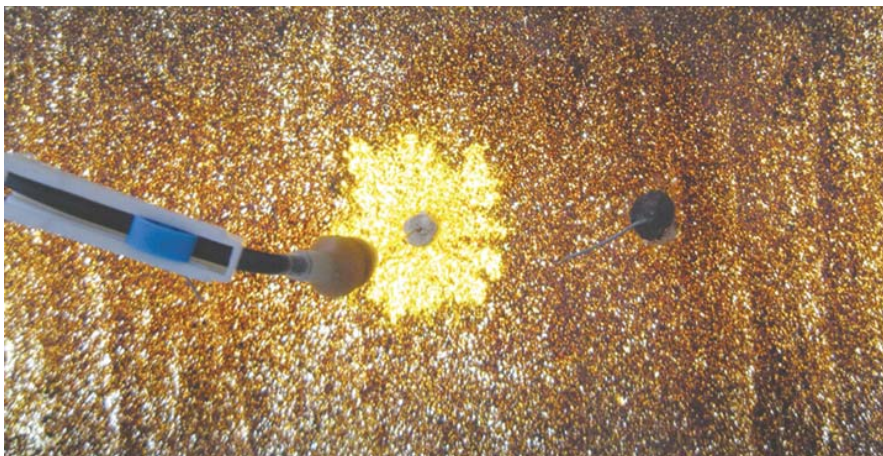
Рис. 2. Обводнение участка пласта путем введения окрашенной уранином воды объемом 2 \text{ см}^3 в центральную скважину
