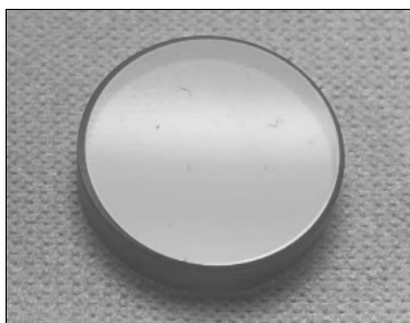
Рис. 7. Диэлектрическое зеркальное покрытие, нанесенное на подложку из ZnSe
