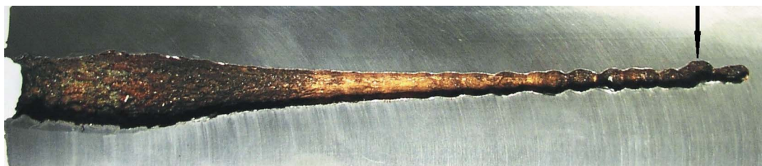
Рис. 9. Каверна в стальной преграде с углублением в боковой стенке
