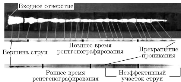
Рис. 4. Форма каверны в сопоставлении с формой и положением элементов струи из [4]
