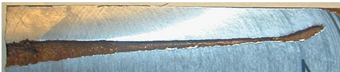
Рис. 3. Разрез каверны, образованной при проникании кумулятивной струи из порошковой композиции
