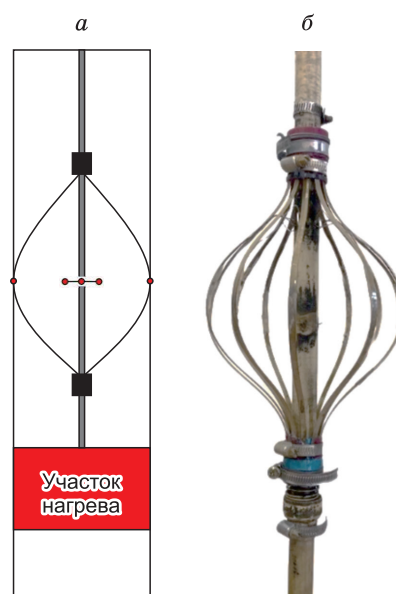
Рис. 4. Положение участка нагрева (а) и общий вид температурного зонда (б).
