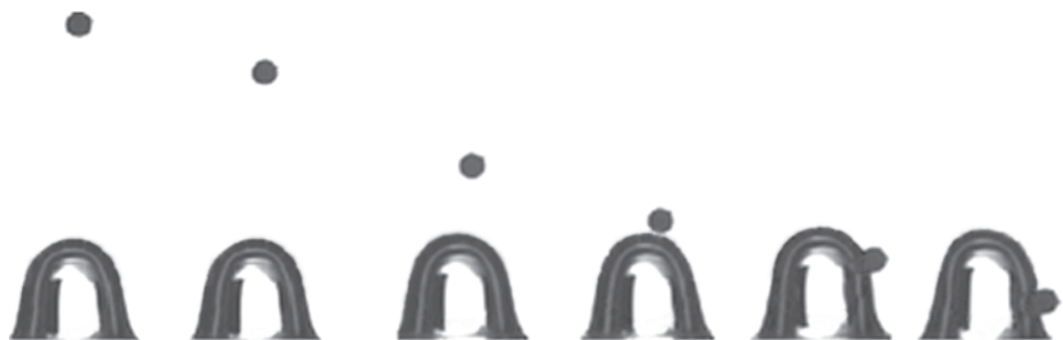
Рис. 3. Движение частицы по поверхности пузырька воздуха ( D_p = 1,5 мм, D_b = 5,5 мм, \sigma = 71 \cdot 10^{-3} Н/м, Bo = 4,255 )
