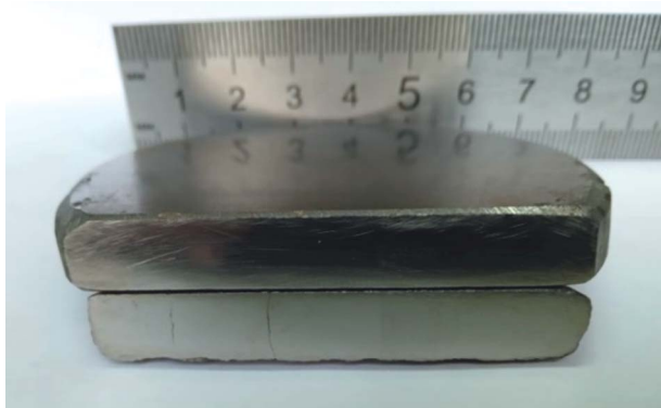
Рис. 6. Фотография сечения шлифованного образца никелида титана
