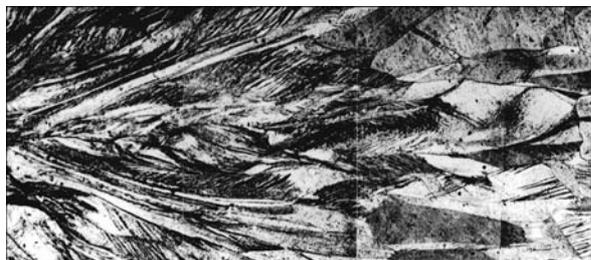
Рис. 2. Макрополоса сдвига в сколлапсированном образце крупнозернистой меди ( $\times 50$ )
