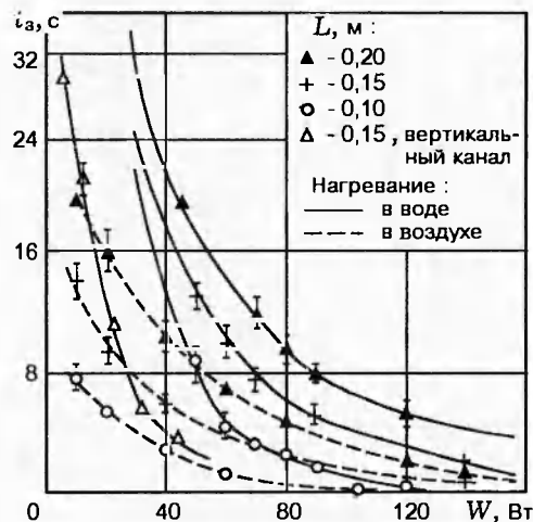
Рис. 5. Зависимости времени зажигания топлива от мощности, подаваемой на спираль: диаметр проволоки 0,5 мм; сплошные линии — нагревание в воде, штриховые — в воздухе
