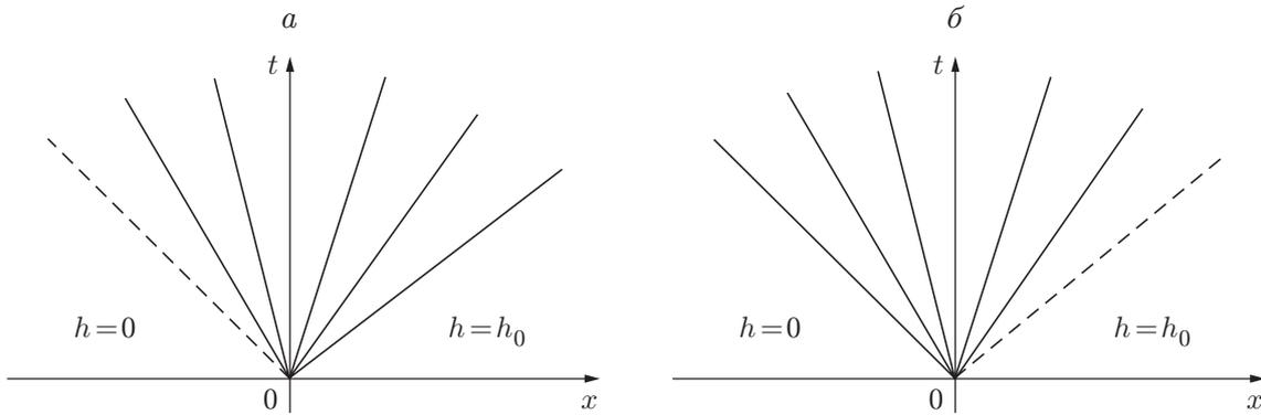
Рис. 4. Возможные волновые конфигурации: устойчивый разрыв (штриховая линия) и простая центрированная волна, примыкающая к фронту разрыва (сплошные линии):
