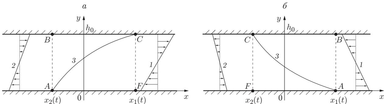
Рис. 1. Двухслойное движение жидкости с положительными (а) и отрицательными (б) кусочно-постоянными завихренностями:
