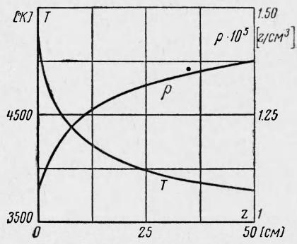
из условия сохранения полной энталпии определялась температура  $T$ , после чего из уравнения состояния — плотность  $\rho$ . Параметры на ударной волне и наклон ее находились совместным решением условий на ударной волне и на характеристике, пересекающей ударную волну.
