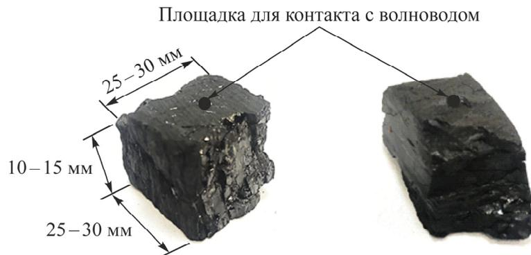
Рис. 1. Характерный внешний вид и размеры исследованных образцов угля
