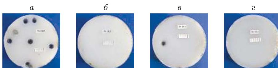
Рис. 4. Образцы из чистого СВМПЭ толщиной 30,4 мм (а, б) и из СВМПЭ толщиной 23,9 мм, армированные пятью перфорированными титановыми лентами (в, г), после испытаний:
