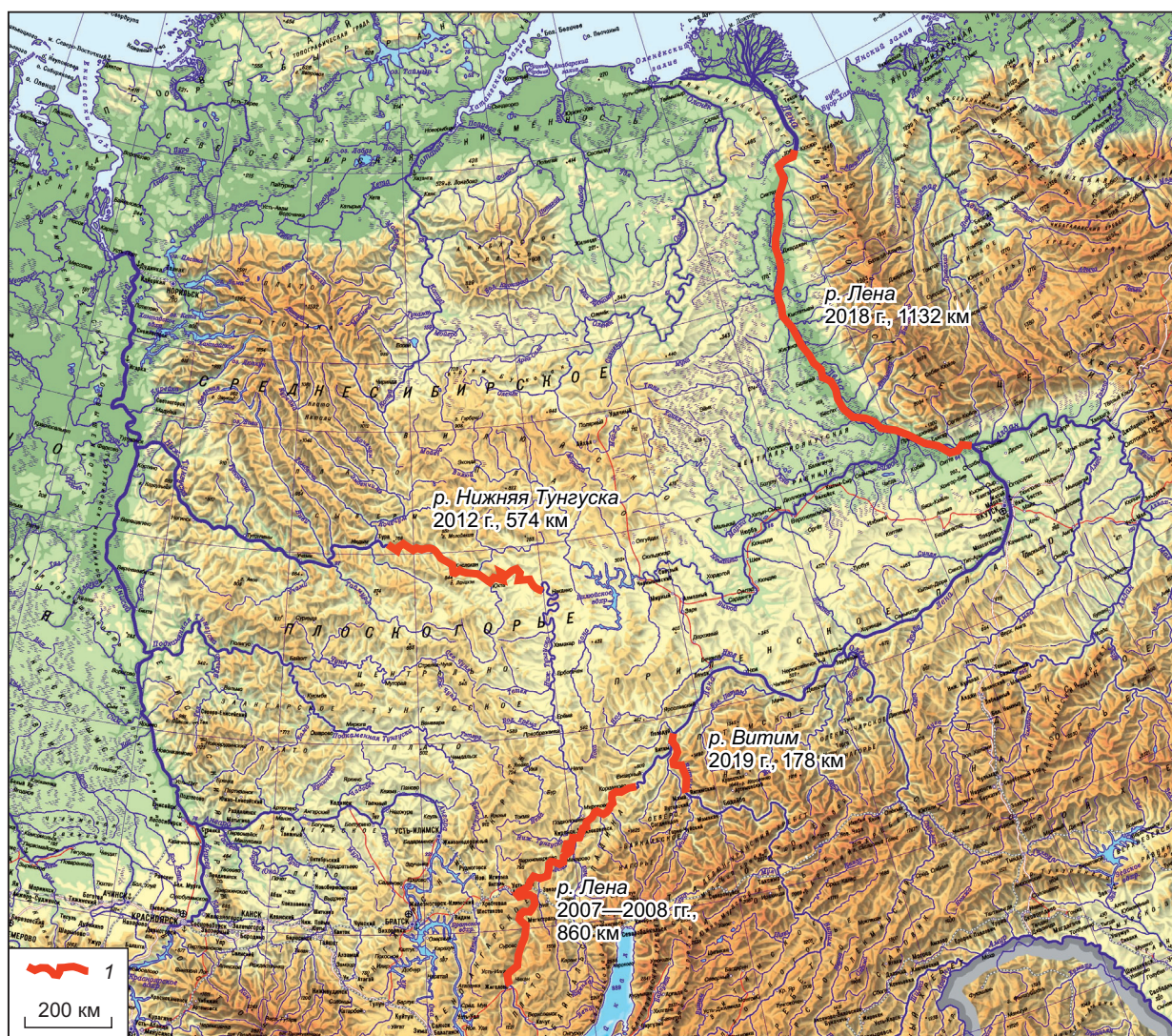
Рис. 1. Схема профилей речной сейсморазведки МОГТ-2D, по которым имеются архивные данные с возможностью переинтерпретации для изучения глубинного строения земной коры.
