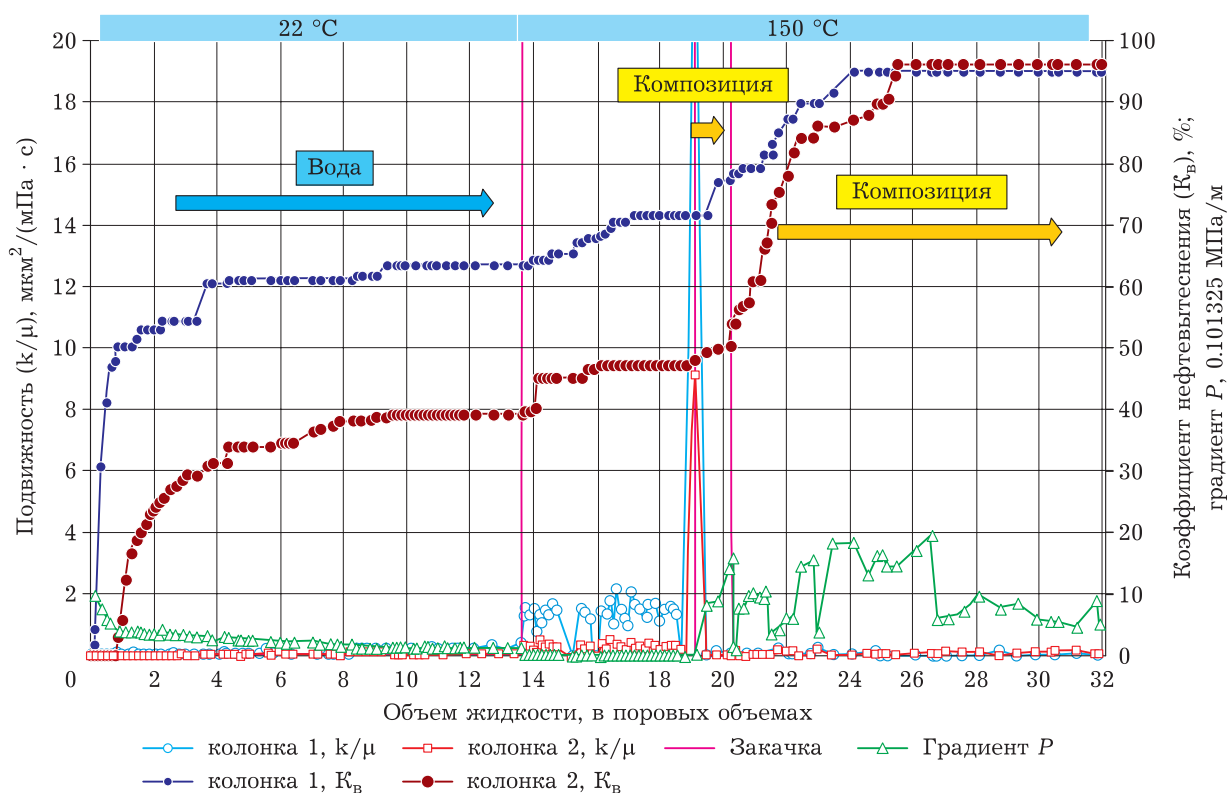
Рис. 9. Прирост коэффициента вытеснения ( K_v ) в модели пласта пермокарбоневой залежи высоковязкой нефти Усинского месторождения после закачки кислотной нефтewытесняющей композиции ГБК на основе ПАВ и ГЭР при 150 °C. Исходная газовая проницаемость ( k ) моделей пласта: 1 колонка – 1.87 мкм 2 ; 2 колонка – 0.97 мкм 2 [36]. ГЭР – глубокий эвтектический растворитель; ПАВ – поверхностно-активные вещества; k/\mu – подвижность, где k – проницаемость, мкм 2 , \mu – динамическая вязкость, мПа·с; P – давление.
