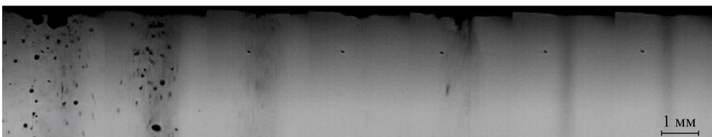
Рис. 8. Газокпельный поток, вытекающий из микроканальной мембраны для HFE-7100 при расходе 2 мл/мин и перепадах давления воздуха (слева направо:  $dP = 1, 2, 3, 5, 6, 7, 8$  бар).
